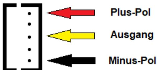
**Die mitgelieferten Stecker sind nicht verpolungssicher! Bitte unbedingt vor dem Anschluss mit einem Voltmeter die Polung an der Sender-Funktionsbuchse**
