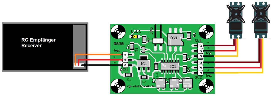
Abbildung 1: Steuerung über Schaltkanal
